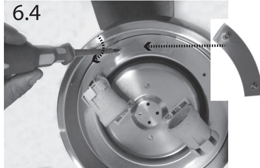
**esp** Asegúrese de que los tornillos quedan bien apretados. **ned** Controleer of de schroeven goed zijn aangedraaid.
